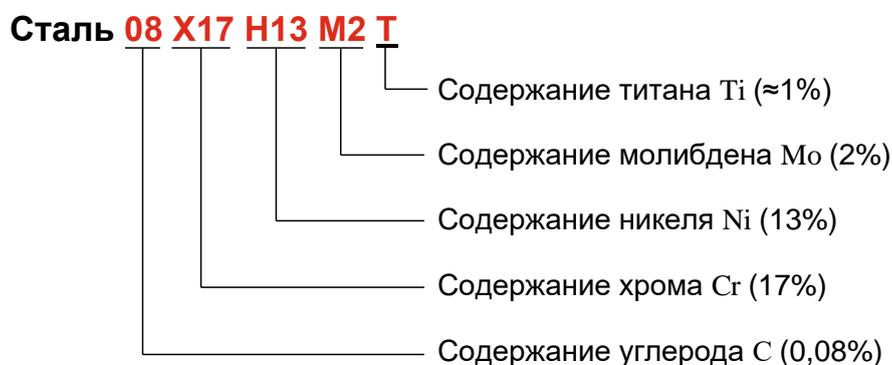
Но в настоящее время достаточно широко используется маркировка, принятая в США – AISI, подразделяющая нержавеющие стали на серии – 200-я, 300-я, 400-я. Ориентировка в марках и сопоставление сталей возможна только при сопоставлении их химического состава.
