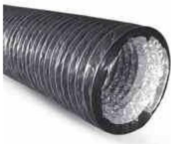
Гибкий воздуховод COMBIFLEX COM-F выполнен из многослойного алюминия, покрытого плотным и негорючим ПВХ-покрытием толщиной 110 микрон. Изделие усилено стальной спиральной пружинной проволокой.
