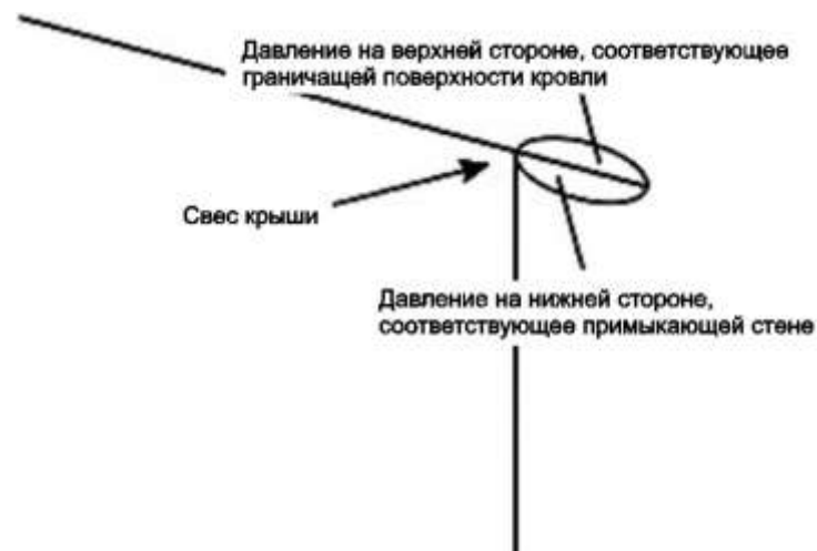
Рисунок 7.3 – Давления при свесе крыши
