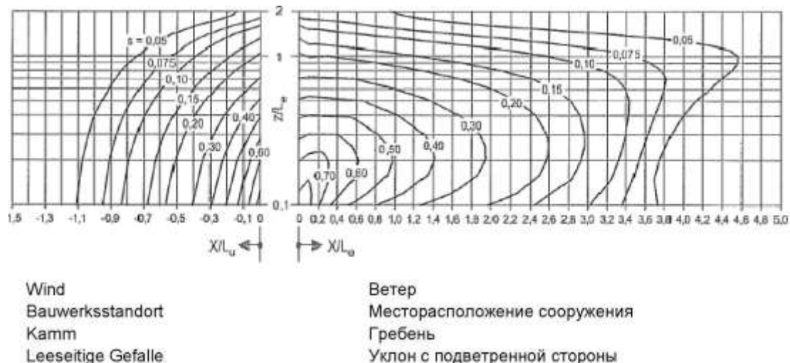
Рисунок А.2 – Коэффициент s для склонов скал или крутых склонов
